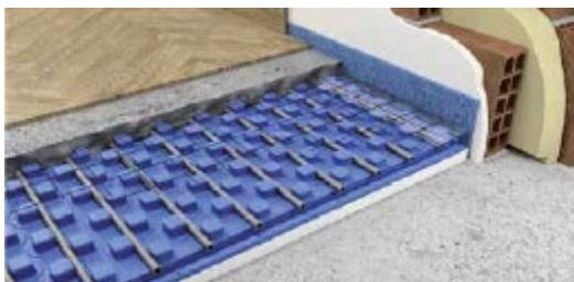
L'impianto di riscaldamento sarà costituito da pannelli radianti a pavimento, integrato mediante termoarredi elettrici nei locali servizi igienici. L'impianto radiante a pavimento sarà con acqua a bassa temperatura.
